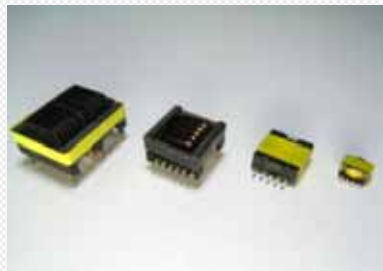
補助電源用トランス
